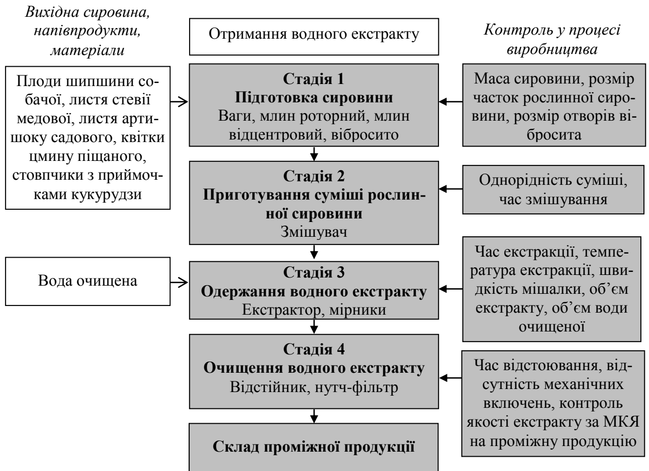
Рис. 3. Схема технологічного процесу отримання проміжного продукту – сумарного водного екстракту з фітокомпозиції
