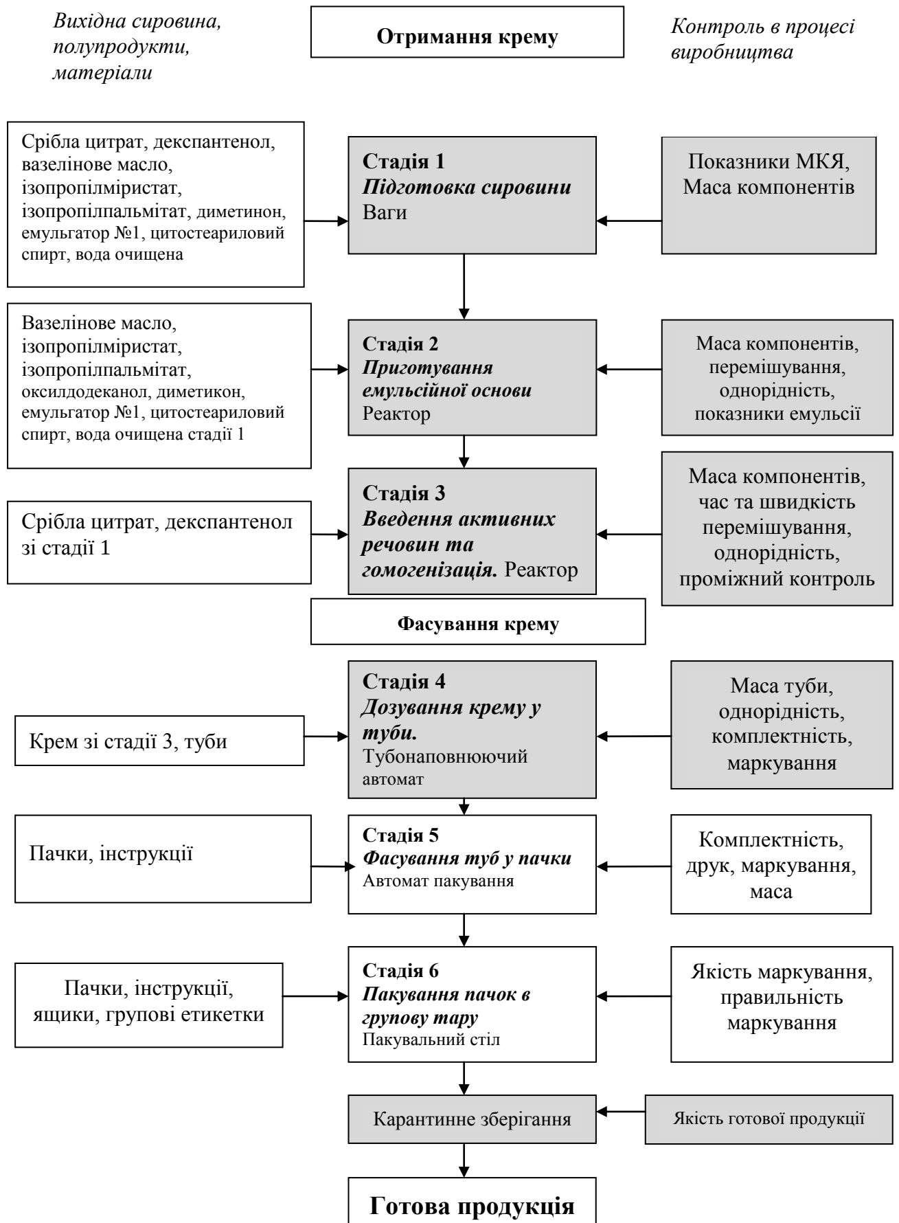
Рис.9 Блок-схема технологічного процесу виробництва крему «Аргоцид К»
