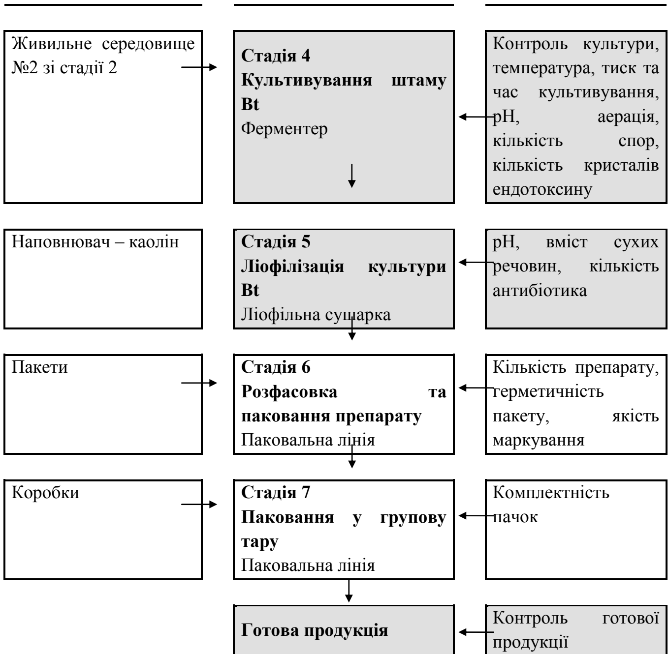
Рис. 1. Технологічна схема виробництва біоінсектициду на основі Bt
